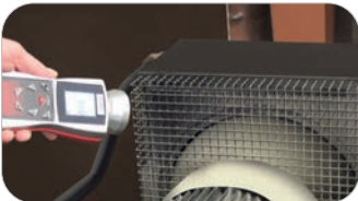
Stroboskop aus: Umdrehungen nicht sichtbar
