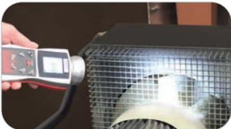
Stroboskop an: Umdrehungen sichtbar
